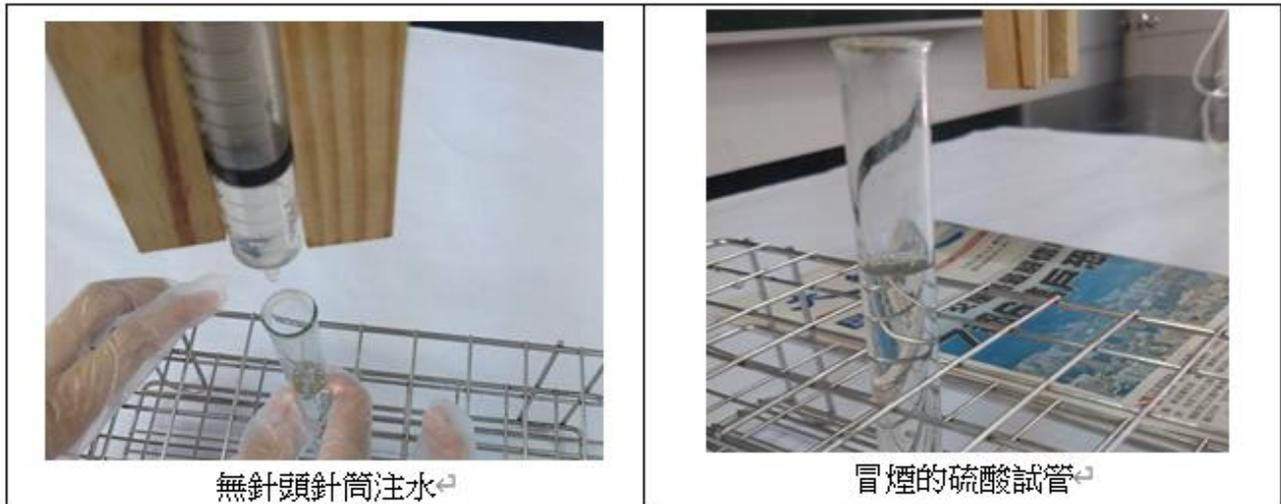
圖 16 試管裝濃硫酸注水的現象
