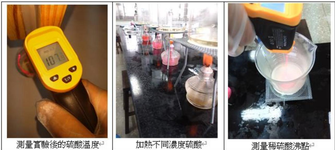
圖 10 為測量實驗後的硫酸溫度及測量不同濃度的硫酸溶液沸點
