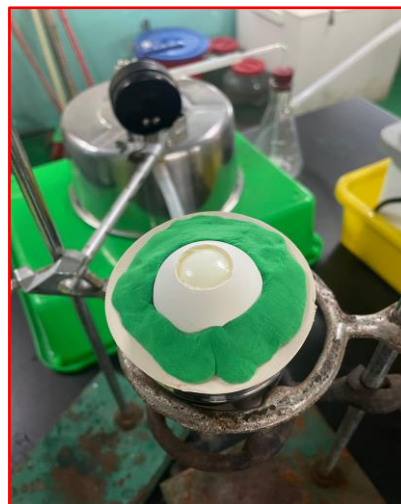
圖十四：將蛋放入橡皮塞，量測蛋殼分離的數據
