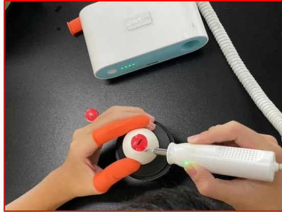
圖十六：貼上標籤紙，以超音波刀進行上、下開口。
