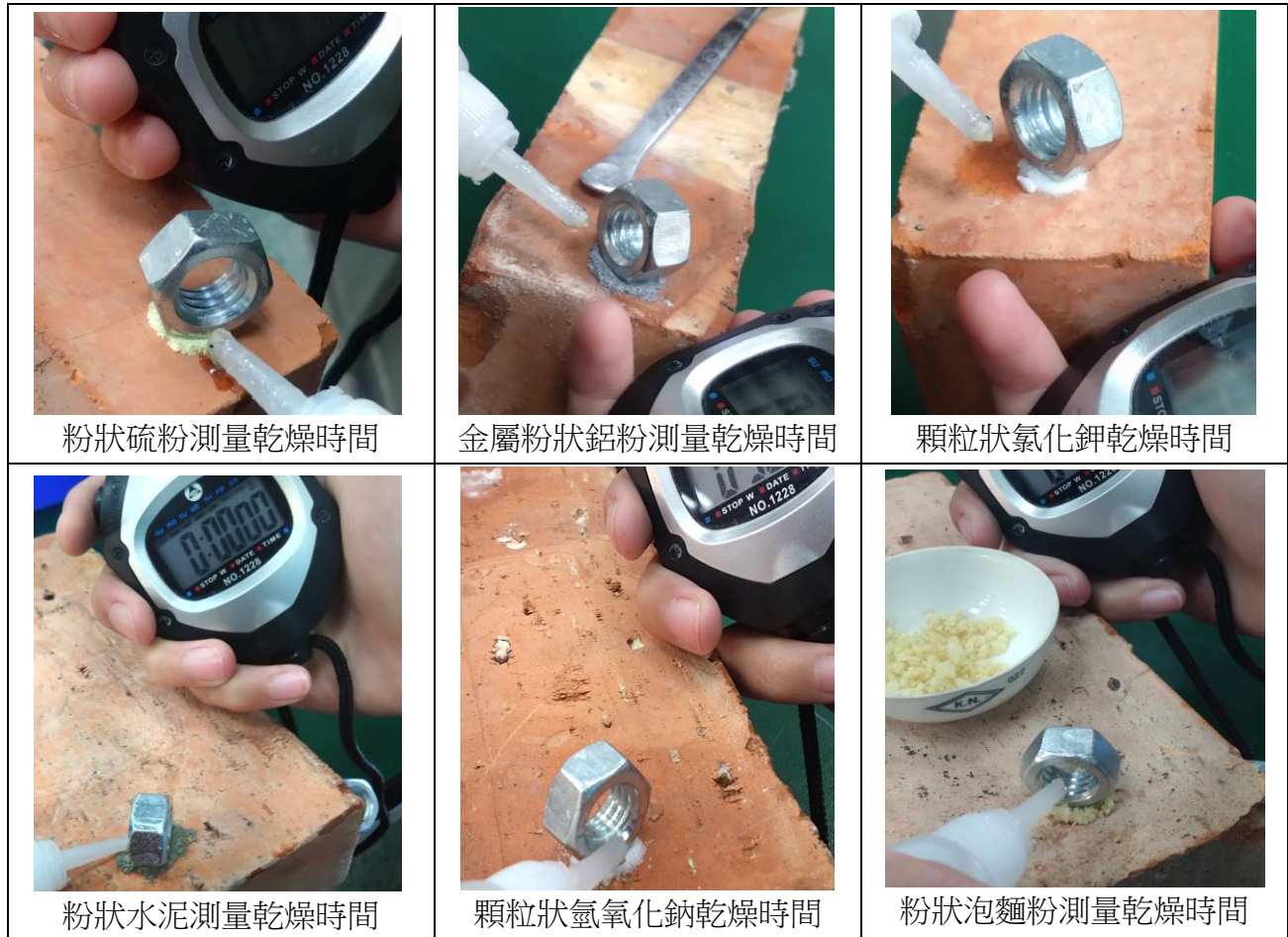
圖 10 為測量各種催化劑添加瞬間膠的乾燥時間
