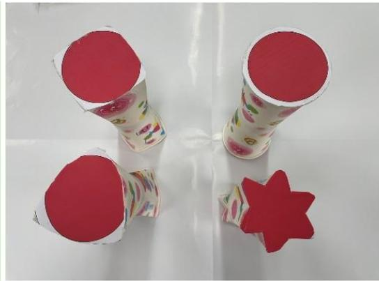
六芒星形開口的飛杯水平飛行距離最短，飛行時不穩定。圓形開口的飛杯飛得最遠。正方形與三角形開口飛行距離差異不大。
