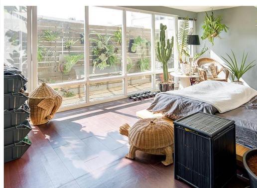
2. 崁入窗（固定式、落地式、高側窗、頂側窗）：直接將玻璃鑲嵌於窗框中，沒有開關機制的固定型設計，多半用因採光和景觀考量而設置，功能單純且可形塑成各式形態和大小，不過清潔上就相對不便。常用於客廳落地設計、高側採光窗及頂側窗引導光線照入室內深處。
