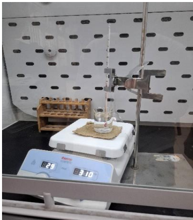
圖二、不同隔熱材料隔熱墊置於電熱板上，調整溫度至 120 度，測試燒杯內水的溫度變化量
