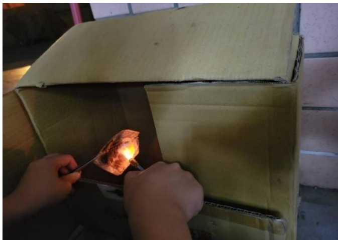
圖十三、不同環保材料以打火機點火燒，測試其材料正反面的溫度差及重量損耗率
