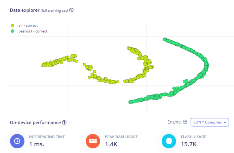
圖二十五: 空氣、產生黃麴毒素的花生粉在 Edge Impulse 的訓練分類分布圖，自行截圖繪製
