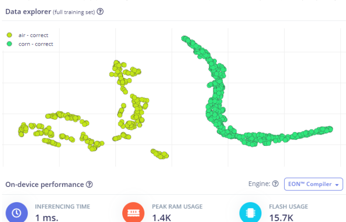
圖三十四: 空氣、產生黃麴毒素的玉米在 Edge Impulse 的訓練分類分布圖，自行截圖繪製
