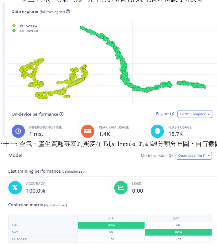
圖三十二:空氣、產生黃麴毒素的燕麥在 Edge Impulse 的混淆矩陣，自行截圖繪製
