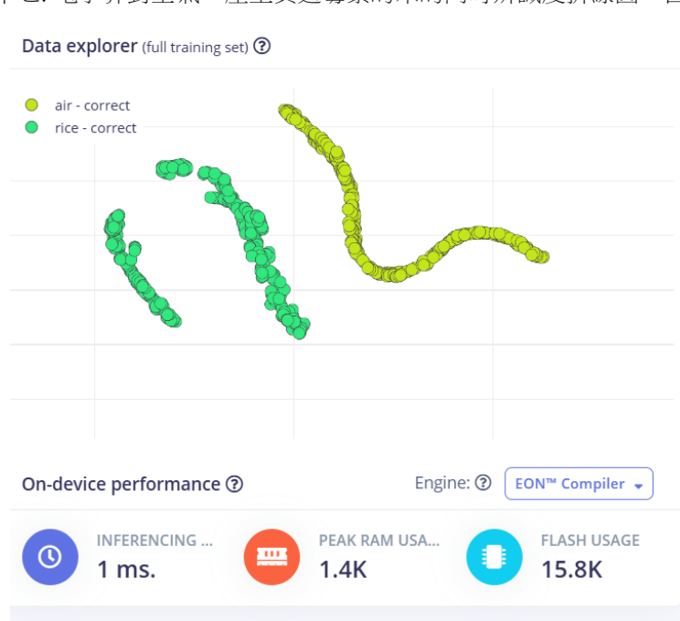
圖二十八: 空氣、產生黃麴毒素的米在 Edge Impulse 的訓練分類分布圖，自行截圖繪製
