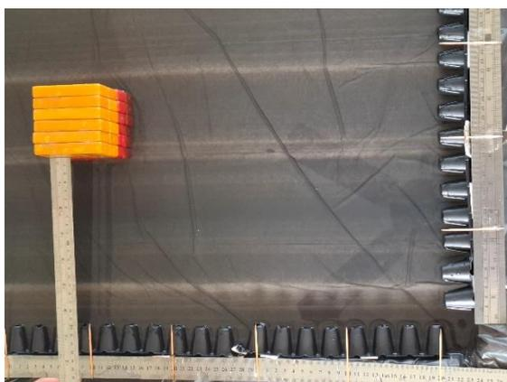
圖3-1 距離底邊20cm的8cm防波堤
