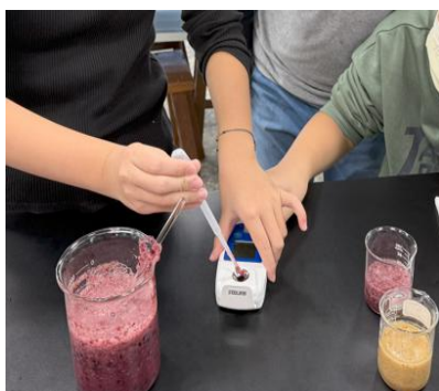
吸取果汁以糖度計測試糖度
