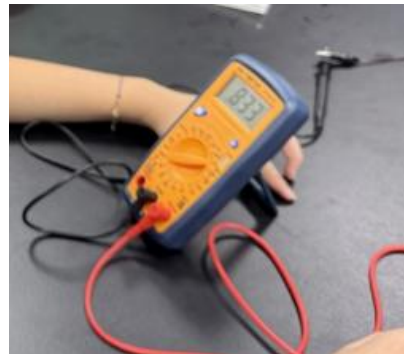
以三用電表測量電流及電壓
