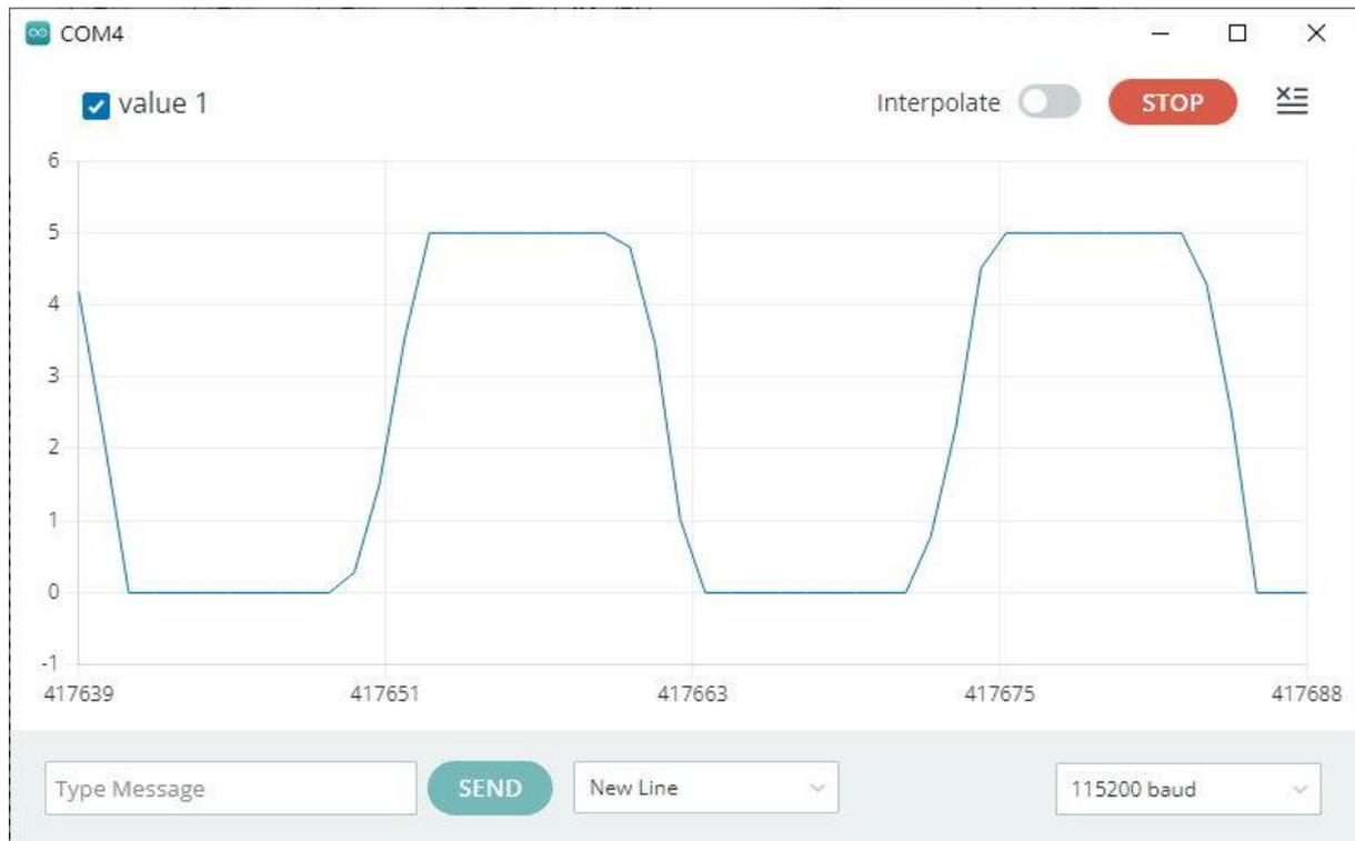
A0 接腳靠近火線時電壓變化
