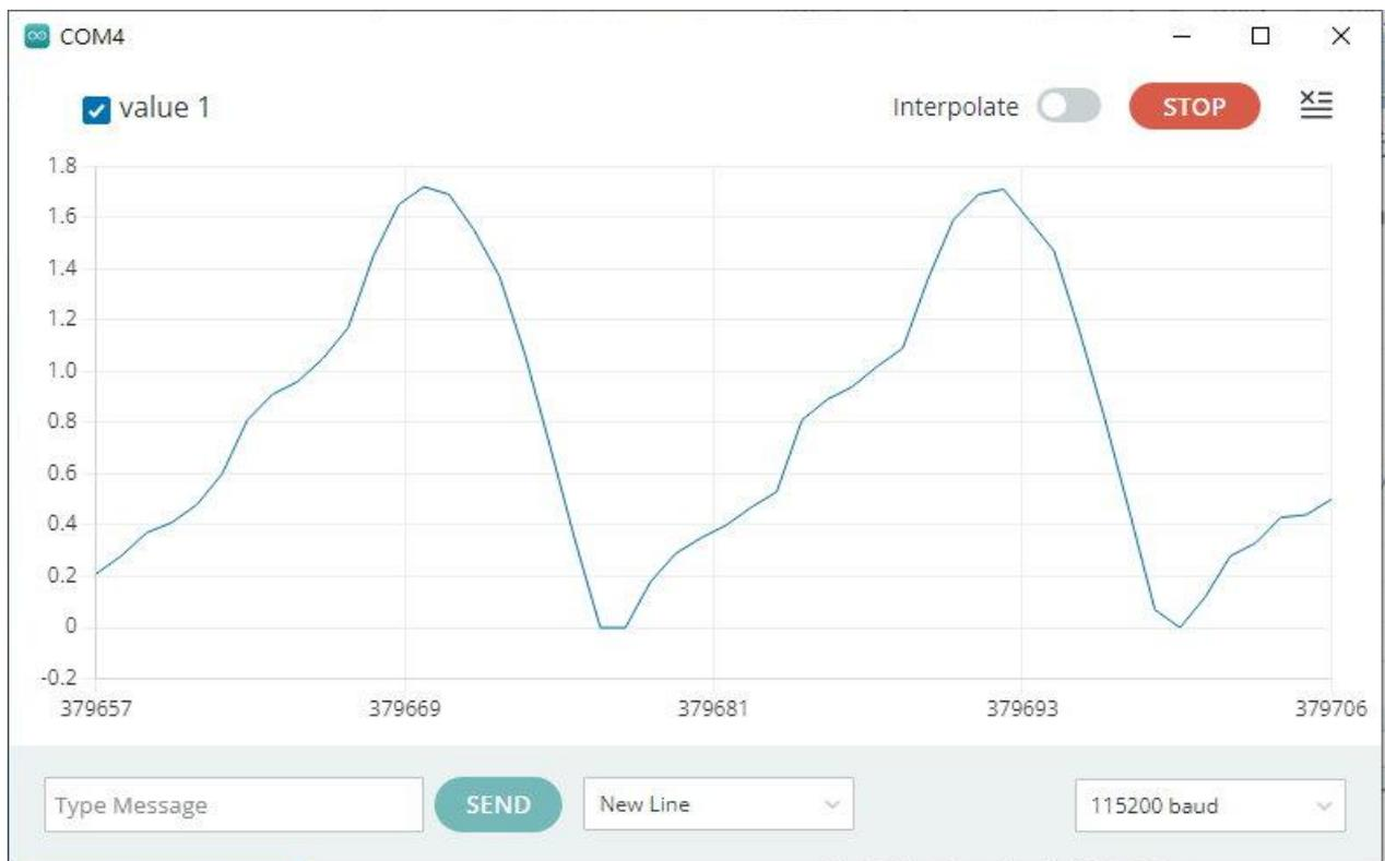
A0 接腳靠近中性線時電壓變化
