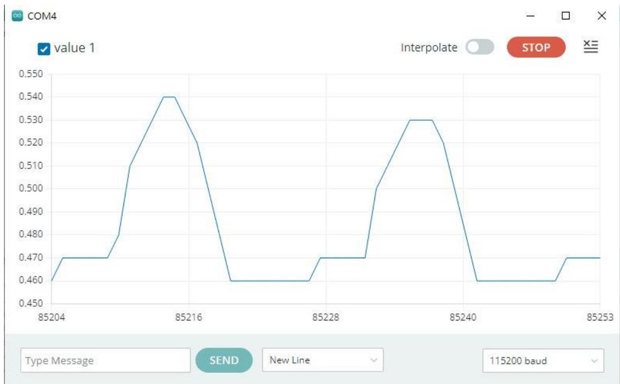
A0 接腳未靠近火線、未靠近中性線時電壓變化，有雜訊產生
