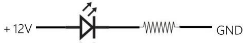
圖二十一 LED 以電阻降壓電路圖
