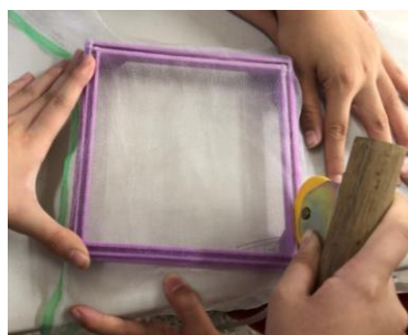
圖十以滾輪將壓條塞入
