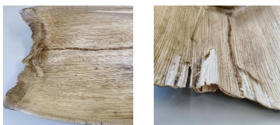
圖1-1 檳榔葉鞘外觀及撕裂後纖維結構示意圖
