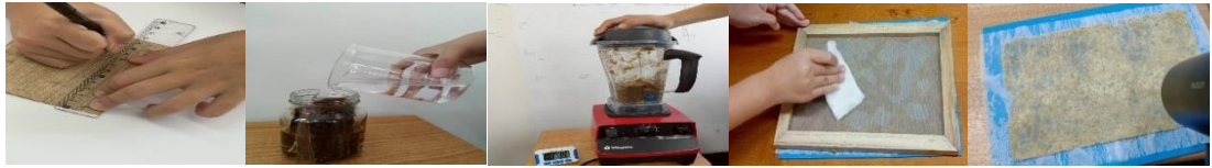
圖3-1 葉鞘前處理與抄紙流程示意圖（裁剪→ 浸泡→ 打漿→ 抄紙→ 乾燥）
