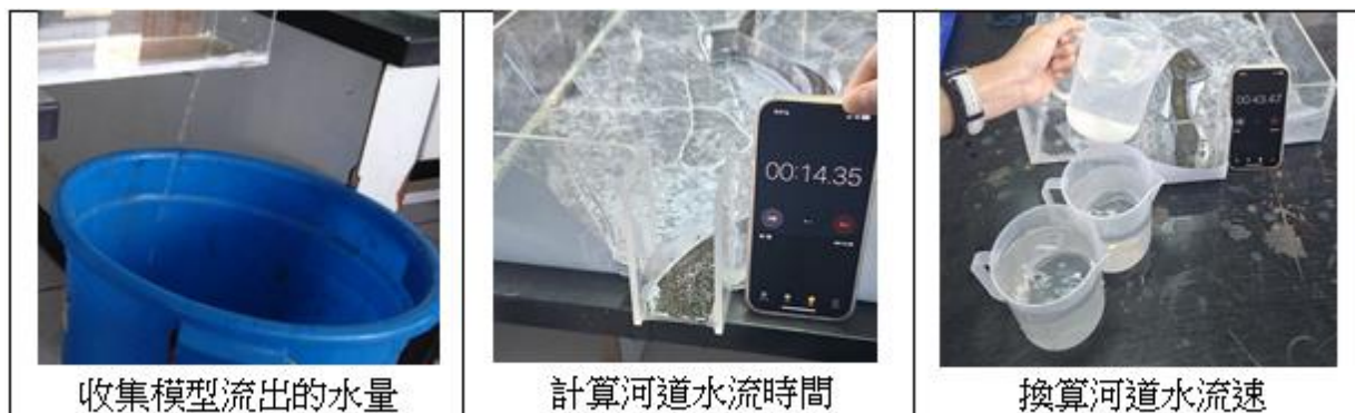
圖 08 為河道水流量和水流速測定
