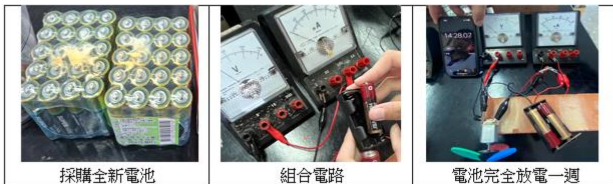
圖 01 為組合出電路並測量電池的放電數據
