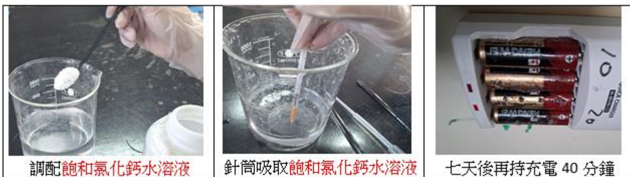
圖 08 為電池內部注射 飽和氯化鈣水溶液
