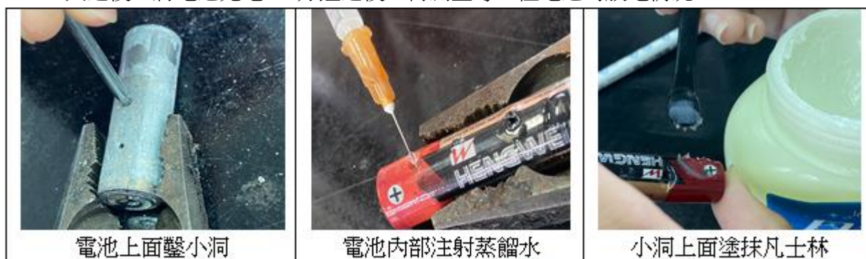
圖 04 為電池內部注射蒸餾水
