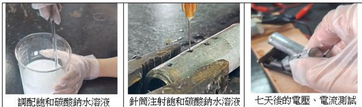
圖 07 為電池內部注射 碳酸鈉水溶液
