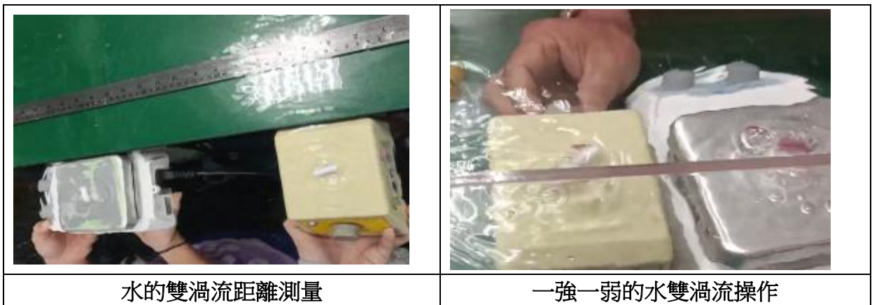
圖 17.為以水為介質的雙渦流磁力攪拌器操作模式
