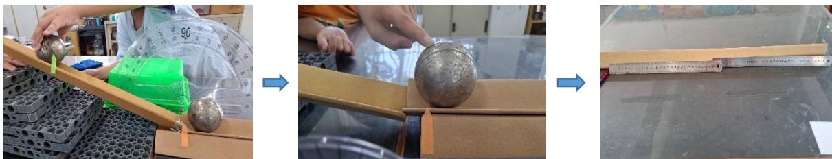
圖 6-8、射擊球與目標球放置點與射擊後量測距離示意圖
