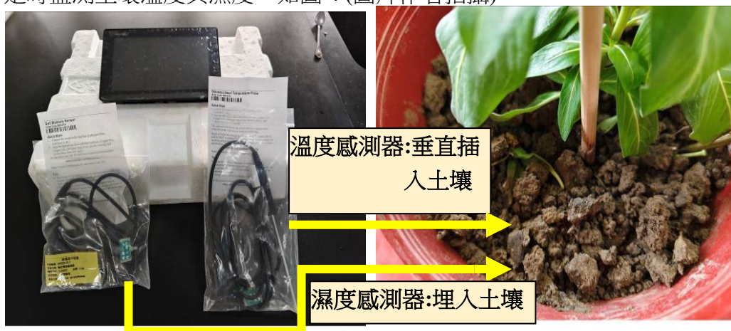
圖 4.土壤溫度與濕度監測方式
