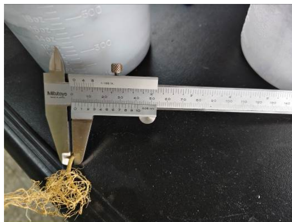
圖 9a.游標尺測量根外徑
