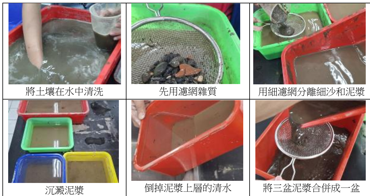
圖 05 為細沙土和泥漿的製備
