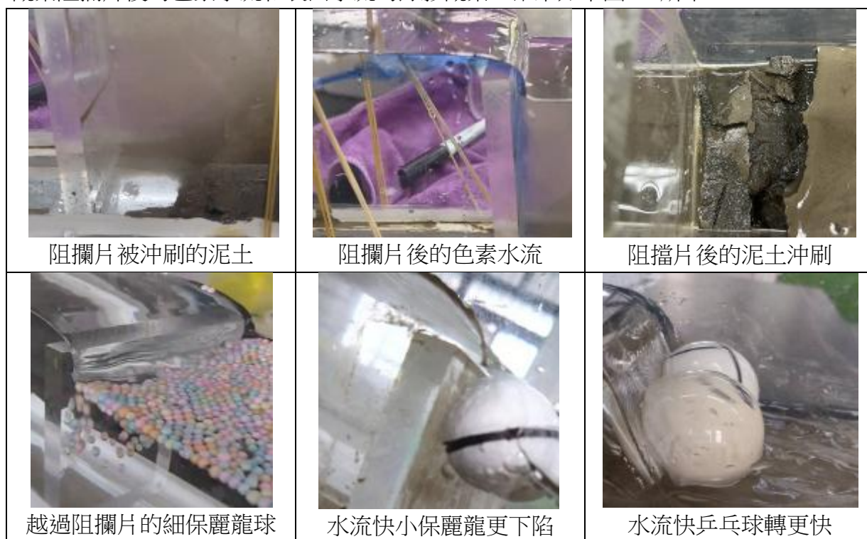
圖 19 為阻攔片後水流的觀測
