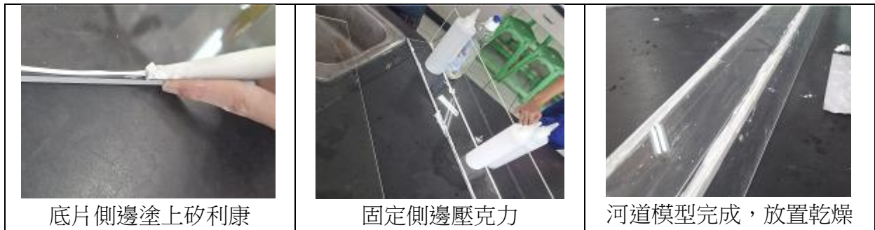
圖 03 為水力河道模型的製作
