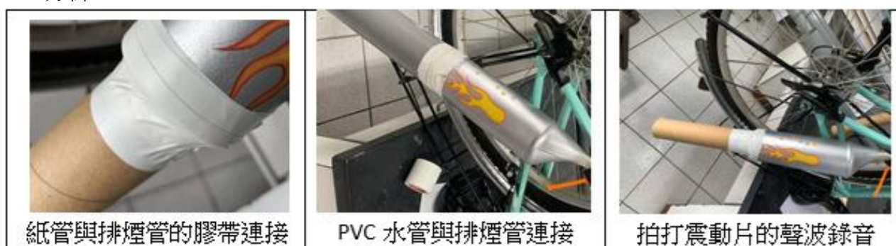
圖 10 為改良後的自行車排煙管聲波錄音
