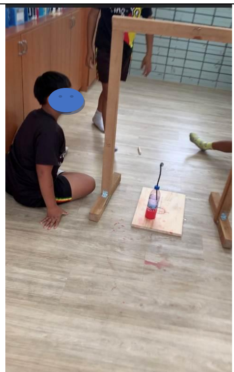
3、小木棍彈起後往後方飛，支架邊學生測量高度，令懷有學生使用皮尺測量飛行距離。
