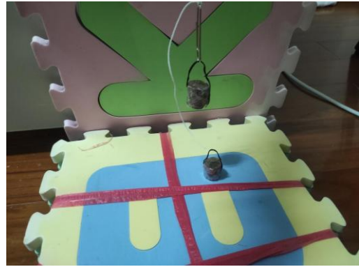
圖 3-20 下置軟墊接住下落的重錘
