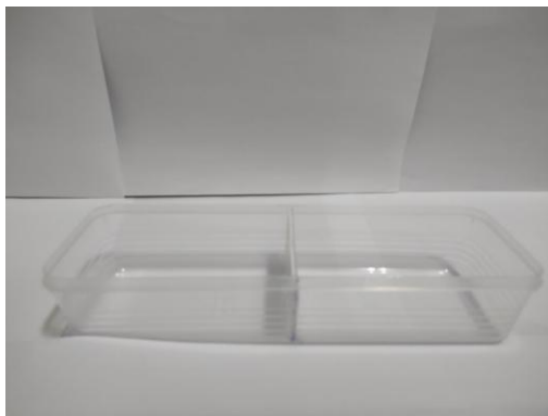
圖 3-7 使用塑膠板來製做防浪隔板
