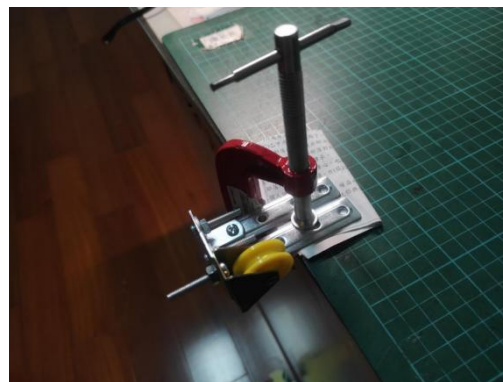
圖 3-4 將定滑輪固定在桌子邊緣
