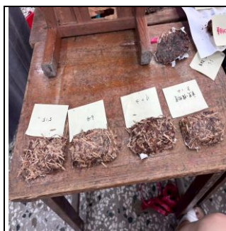
1.不同比例之檳榔葉與去內膜之可可果莢混合製成板材。
