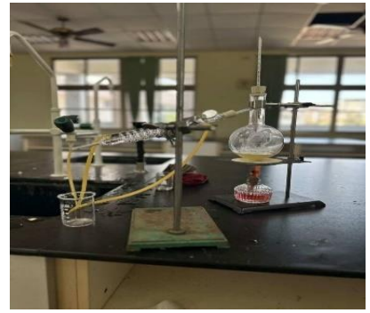
以蒸餾法冷凝來提升小米酒濃度
