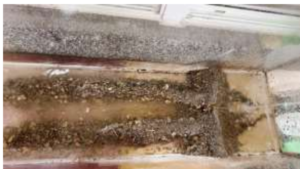
左上圖為德文村土壤堰塞湖堤防開始模擬下雨，右上圖為德文村土壤堰塞湖開始滲水 左下圖為德文村土壤堰塞湖開始潰堤，左下圖為德文村土壤堰塞湖持續潰堤 (以上相片為智慧型手機攝影之截圖)
