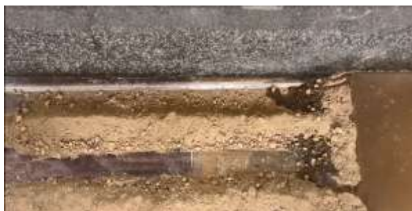
左上圖為三地村土壤堰塞湖堤防開始模擬下雨，右上圖為三地村土壤堰塞湖開始滲水 左下圖為三地村土壤堰塞湖開始溢流，左下圖為三地村土壤堰塞湖潰堤 (以上相片為智慧型手機攝影之截圖)
