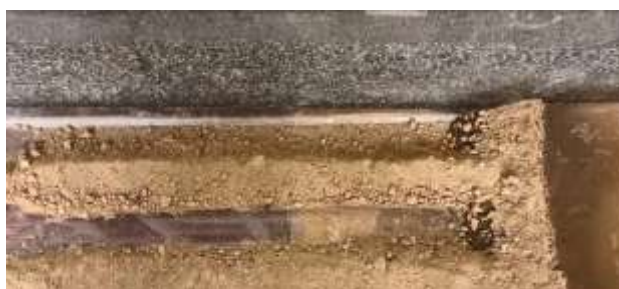
左上圖為德文村土壤堰塞湖堤防開始模擬下雨，右上圖為德文村土壤堰塞湖開始滲水 左下圖為德文村土壤堰塞湖開始潰堤，左下圖為德文村土壤堰塞湖持續潰堤 (以上相片為智慧型手機攝影之截圖)
