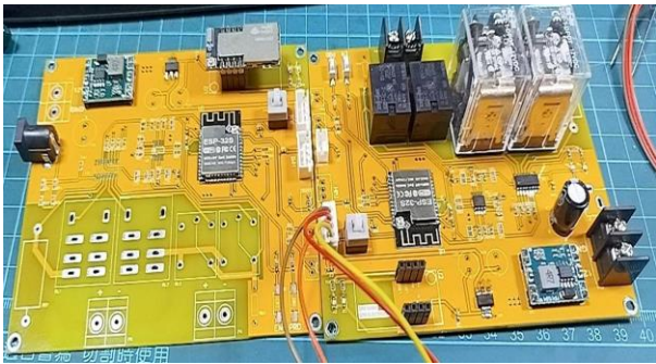
圖 4-8 捲軸式太陽能板控制電路板焊接 (作者截圖)
