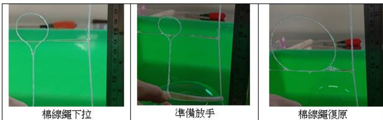
圖 12 為棉線繩的下拉和復原測量棉線繩的直徑變化
