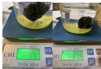
圖十一、新竹「啟源堂-礦物顏料製作工坊」新岩黑色比重測試
