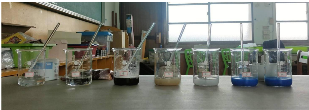
圖二十四、實驗 1：色粉的分散性—觀察色粉是否能直接溶於水實驗過程圖
