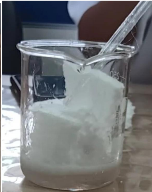
圖 7-1 乙酸乙酯溶解低密度保麗龍狀況
