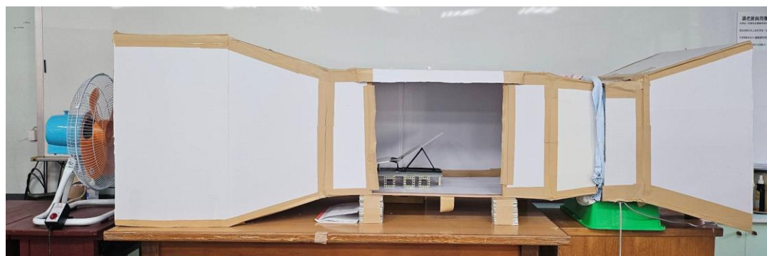
圖 3-3 風洞完成圖。為了使排風順暢，排風口處為實驗室的前門，實驗時會將前門打開。
