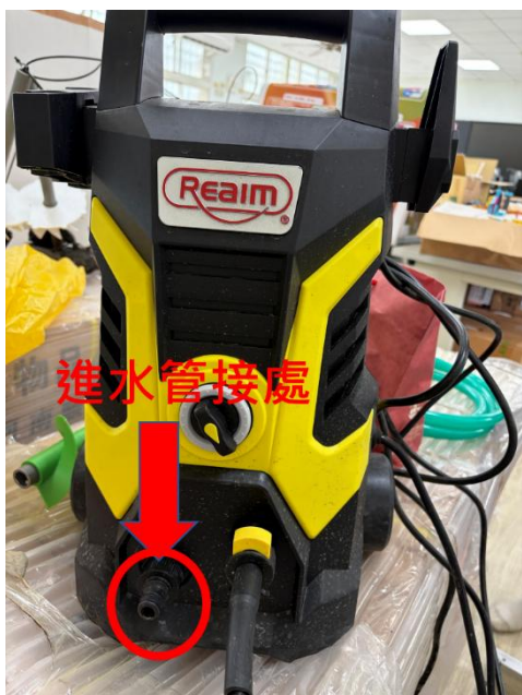
圖 11:進水管接到水龍頭水管
