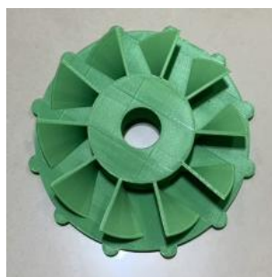
圖 25: 圓孔和水管直徑 22mm 太相近，難以帶動轉盤
