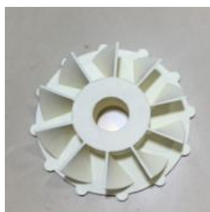
圖 27: 轉盤中心圓孔直徑 27.5mm，可以順著水流轉動
