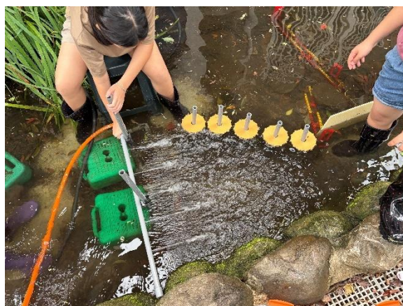
圖 14:運用 PVC 管及大型夾子製作水道模擬器固定裝置
