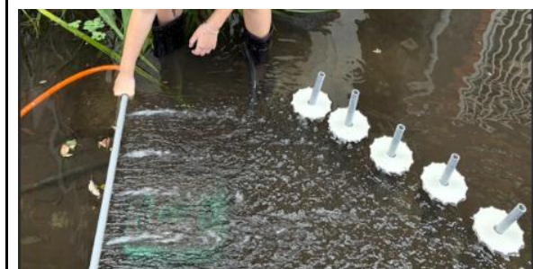
圖 26:轉盤中心圓孔直徑 27.5 mm
