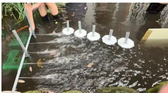
圖 13:將轉盤中心裝置固定於河道
