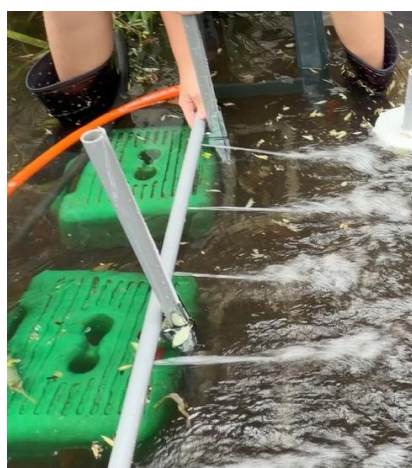
圖 14:運用 PVC 管及大型夾子製作水道模擬器固定裝置
