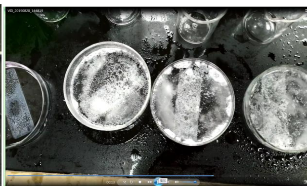
圖 6-2-2 高溫下酸和鹼混合時清除油垢的情形
