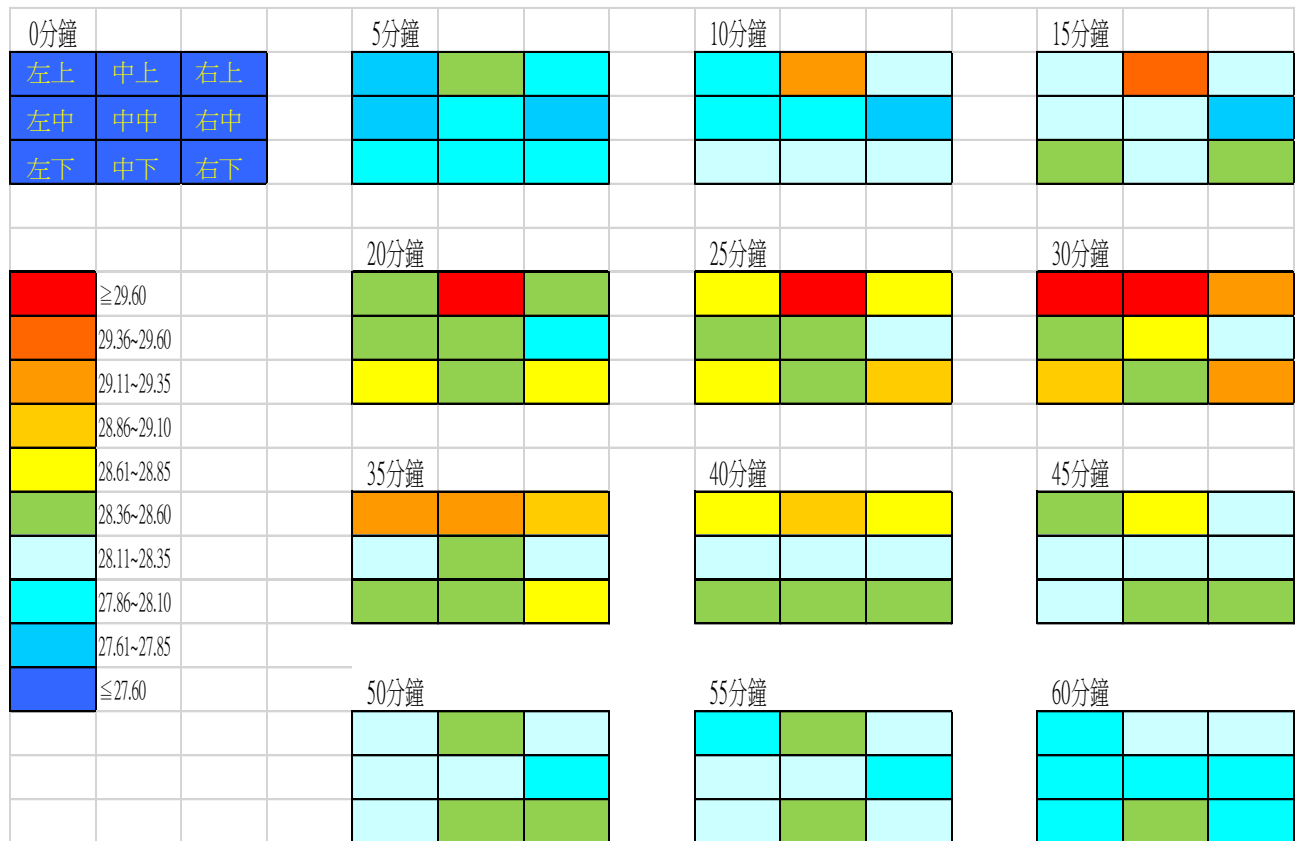
圖 7-3 40%綠地比例面積中央集中式排列之上、中、下層溫度熱流變化圖
