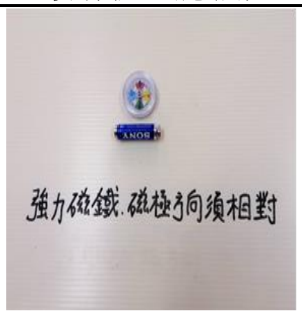
圖〈8〉兩端強力磁鐵的磁極方向必須同極相對 (N 極對 N 極)
