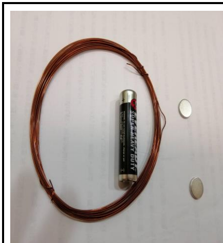
圖〈1〉製作電磁火車材料為銅線、乾電池及強力磁鐵
