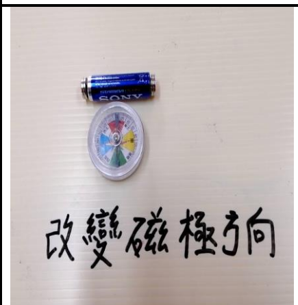
圖〈9〉磁極改變, 指北針的測試
