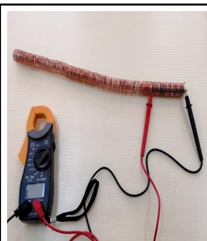
圖〈20〉線圈數愈少，磁力愈弱
