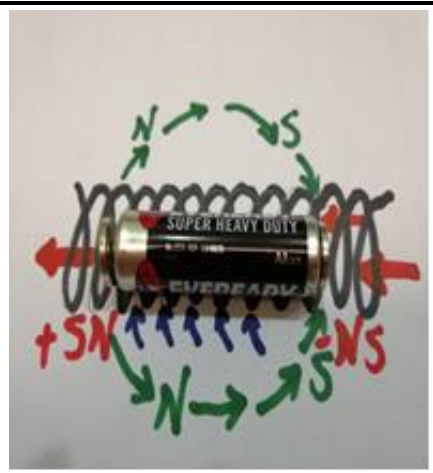
圖〈5〉強力磁鐵會與線圈接觸並將電池中的電流導引到線圈上, 使線圈產生感應磁場
