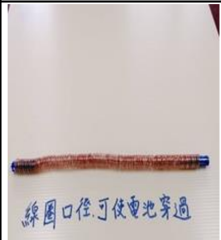
圖〈6〉纏繞線圈口徑須讓乾電池穿過。
